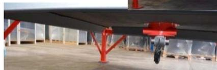
Vibro-moteur avec pôt d'extraction sont vissés central au fond du volummax sur les points marqués.
