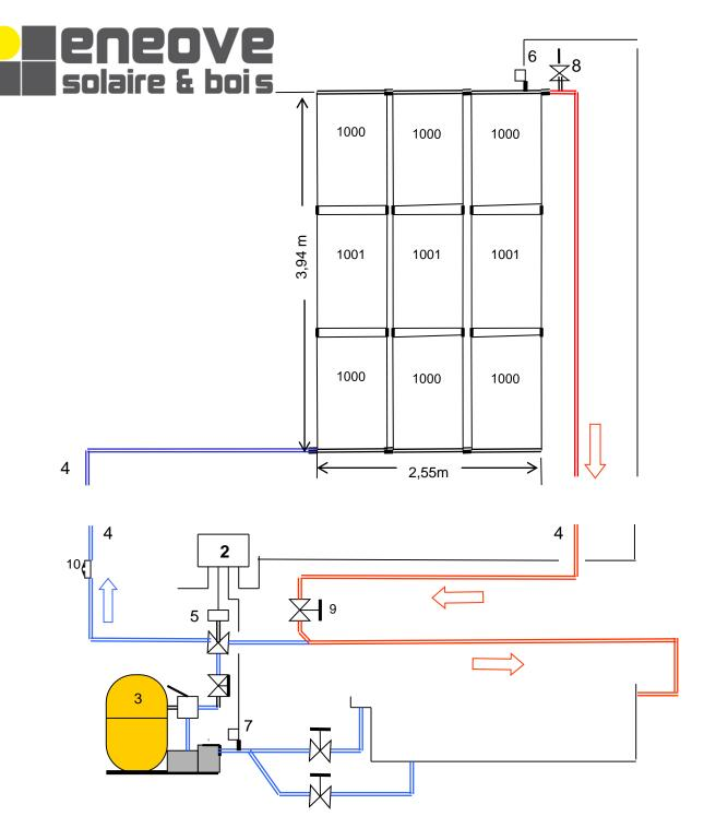
Chauffage solaire pour une piscine avec 9 panneaux SolAbsorb, fonctionnement avec la pompe du filtre, vanne à trois voies motorisée et régulateur de différentiel de température
