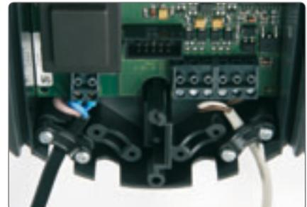
Serre-fils pour tous les câbles. Branchement électrique simple à travers bornes enfichables.
