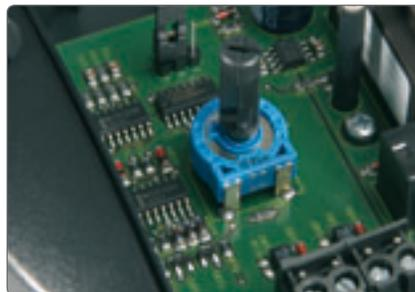
Potentiomètre pour température différentielle et limitation de température minimale ou bien maximale
