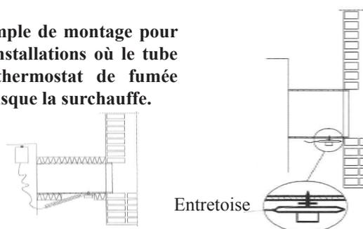
**Conditions de garantie = température maximale au niveau du bulbe 300°C**
