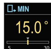
À l'aide des boutons  $\ominus$  et  $\oplus$  vous pouvez déterminer le réglage du seuil minimal de la température demandée en mode refroidissement. Validez le paramétrage à l'aide du bouton  $\odot$ . Si vous avez accidentellement sélectionné le mauvais seuil minimal, vous pouvez revenir à la sélection du seuil minimal à l'aide du bouton  $\odot$ .
