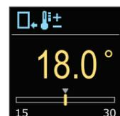
À l'aide des boutons  $\ominus$  et  $\oplus$ , vous pouvez déterminer la température demandée en mode refroidissement. Validez le paramétrage à l'aide du bouton  $\odot$ . Si vous avez accidentellement sélectionné la mauvaise température, vous pouvez revenir à la sélection de température demandée à l'aide du bouton  $\odot$ .
