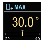
À l'aide des boutons  $\ominus$  et  $\oplus$  vous pouvez déterminer le réglage du seuil maximal de la température demandée en mode refroidissement. Validez le paramétrage à l'aide du bouton  $\odot$ . Si vous avez accidentellement sélectionné le mauvais seuil maximal, vous pouvez revenir à la sélection du seuil maximal à l'aide du bouton  $\odot$ .
