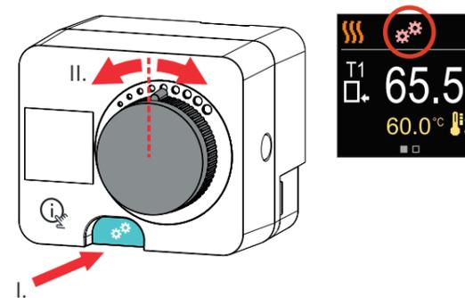
**i** Lorsque l'embrayage est activé, la commande de la valve de mélange s'arrête. Le symbole d'embrayage apparaît à l'écran.
