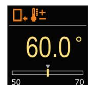
À l'aide des boutons  $\ominus$  et  $\oplus$ , vous pouvez déterminer la température demandée en mode chauffage. Validez le paramétrage à l'aide du bouton  $\odot$ . Si vous avez accidentellement sélectionné la mauvaise température, vous pouvez revenir à la sélection de température demandée à l'aide du bouton  $\odot$ .
