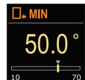
À l'aide des boutons  $\ominus$  et  $\oplus$ , vous pouvez déterminer le paramétrage du seuil minimal de la température demandée en mode chauffage. Validez le paramétrage à l'aide du bouton  $\odot$ . Si vous avez accidentellement sélectionné le mauvais seuil minimal, vous pouvez revenir à la sélection du seuil minimal à l'aide du bouton  $\odot$ .
