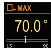
À l'aide des boutons  $\ominus$  et  $\oplus$ , vous pouvez déterminer le réglage du seuil maximal de la température demandée en mode chauffage. Validez le paramétrage à l'aide du bouton  $\odot$ . Si vous avez accidentellement sélectionné le mauvais seuil maximal, vous pouvez revenir à la sélection du seuil maximal à l'aide du bouton  $\odot$ .
