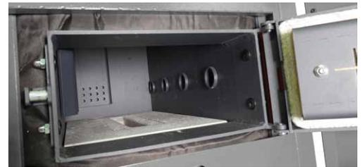
Fig. 14 : Paroi chaudière / ouvertures air primaire
