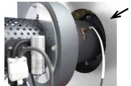
Fig. 16 : Capteur fumées d'échappement
