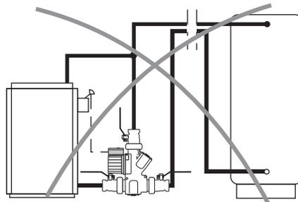
*Le tuyau partant du fond du ballon tampon ne doit pas remonter vers le plafond. Cela rendrait l'auto circulation (thermo siphon) impossible.*
